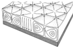
Abb. 1: Strömungsformen in der Bénard-Zelle (aus M. G. Velarde, C. Normand, Scientific American, July 1980 mit Zustimmung von M. G. Velarde)
