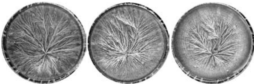
Abb. 1: Kupferchloridkristallisation der Weizensorten (von links) Capo, Lux und Goldblume (150 mg \text{CuCl}_2 , 56 mg Mehleinwaage)
