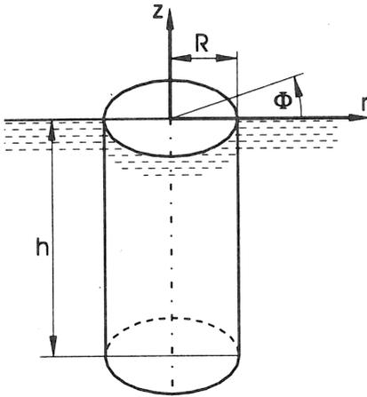
Bild 1: Koordinatensystem.  $z=0$ : Wasseroberfläche, die mit der oberen Endfläche des Zylinders zusammenfällt
