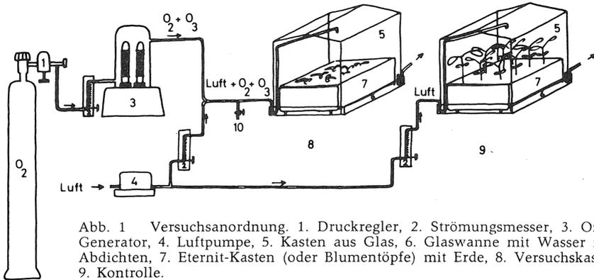
Abb. 1 Versuchsanordnung. 1. Druckregler, 2. Strömungsmesser, 3. Ozon-Generator, 4. Luftpumpe, 5. Kasten aus Glas, 6. Glaswanne mit Wasser zum Abdichten, 7. Eternit-Kasten (oder Blumentöpfe) mit Erde, 8. Versuchskasten, 9. Kontrolle.
