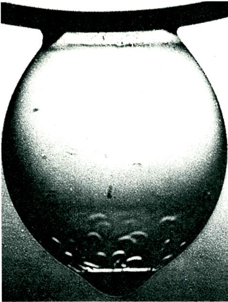
Bild 1: Kugelige, an einem Drahtstück hängende Lamelle (Schlierenaufnahme).
