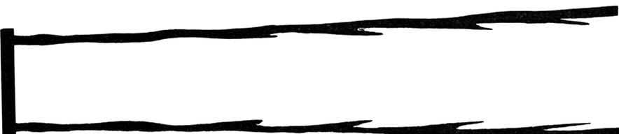
*Bild 2:* Farbfäden an den Grenzen des laminaren Strahls
