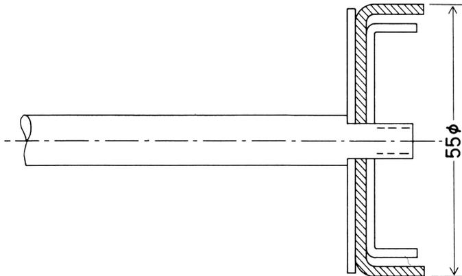
*Bild 2:* Kolben an Stange ohne Befestigungsmutter. Der schraffierte Teil ist aus Leder. Sobald im Innern des Zylinders ein Unterdruck entsteht, hört die Wirkung der Dichtung auf und Luft kann ins Innere fließen. Bei Überdruck im Innern dichtet die an der Zylinderfläche anliegende Fläche ab.
