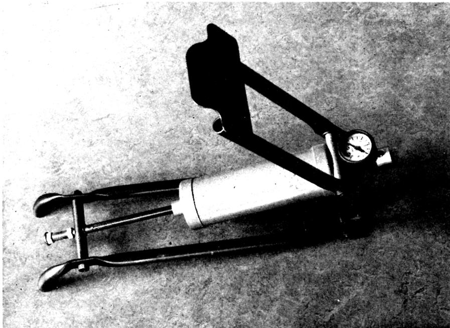
*Bild 1:* Abgeänderte Luftpumpe. Links im Bild ragt die Treibstange über den Steg hinaus. Da der Zylinder am Steg anstösst, werden Hub und Kompression damit verringert. Statt des Druckschlauchs ist ein Verschluss (ganz rechts im Bild) angebracht. Das Kugelventil vor dem Manometer wurde ausgebaut.
