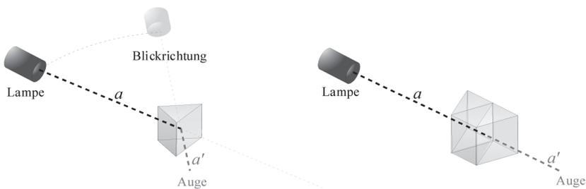
*Abb. 1:* Perspektivische Ansicht eines einfachen Aufbaus zur Erzeugung von Dispersionsfarben. Man blickt durch ein Prisma auf ein kontrastreiches Bild. In der Darstellung links ist die hebungsbedingte Bildverrückung der durchs Prisma gesehenenen Lampe schematisch angedeutet. Rechts ist der Aufbau unter Verwendung eines Geradsichtprismas dargestellt. Mit  $a$  wird der Abstand des Kontrastbildes vom Prisma, mit  $a'$  der Abstand des Beobachters von diesem bezeichnet.
