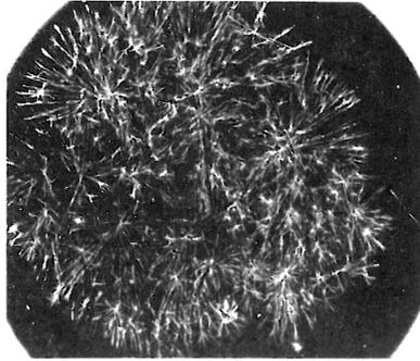
Bild 1:  $\text{CuCl}_2$ -Kristallisation ohne Zusätze (5%ig Lösung)
